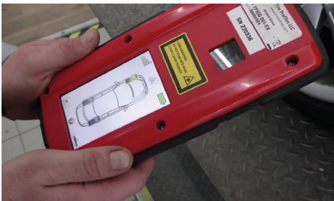
Ein Profiltiefenmesser ist bei Räderwechseltagen ein praktischer Helfer, um den Kunden über den Reifenzustand aufzuklären.
